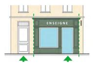
**OUI :** Les bords de la devanture s'alignent à l'axe des trumeaux des niveaux supérieurs. On laissera libre l'accès aux niveaux supérieurs.
