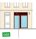
Bloc de climatisation dissimulé derrière une grille à ventelles intégrée dans une imposte.
